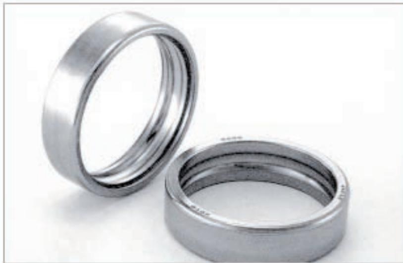
**TRATAMIENTO TÉRMICO** – Antes que los anillos sean rectificadas, necesitan de un tratamiento térmico para proporcionar dureza, y resistencia al desgaste y a la fatiga. En esta etapa las partes son endurecidas o superficialmente carburizadas para darle la dureza Rockwell C necesaria.
