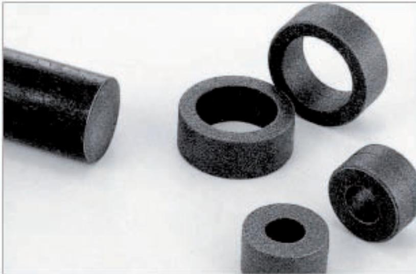
**TORNEADO DE LOS ANILLOS** – Los anillos forjados son luego enviados al Centro de torneado, para ser torneados, maquinados y así lograr las formas de las partes requeridas.
