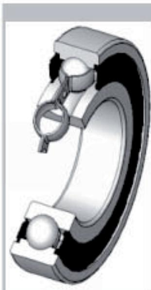
Las jaulas de los elementos rodantes deben ser capaces de mantener el espacio apropiado entre ellos. Deben tener la fortaleza para soportar la fuerza centrífuga y de choque y tolerar las variaciones de temperatura y lubricación.
